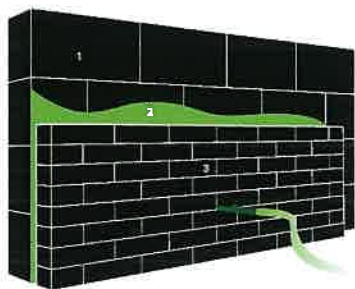
1. Dragende muur | 2. Ingeblazen isolatie | 3. Gevelsteen / gevelbekleding
